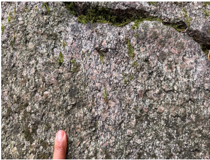
Abbildung 6. Der Granit des Wildfrauhauses ist ein grobkörniger Granit mit Quarz (grau, glänzend), Kalifeldspat (rosa; Orthoklas/Mikroclin), Plagioklas (weißgrau, matt), Biotit (schwarz, glimmernd), ± Hornblende
